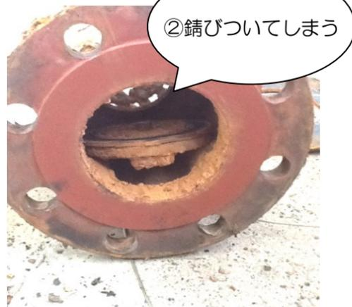
②フート弁は水中に設置しているため、数年で錆が出来てしまう。落水の原因になるため、引き上げ清掃をしている。
