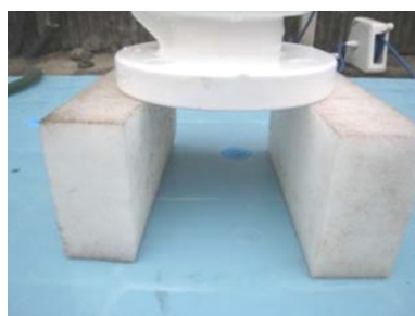
図8 漏水有無の確認
