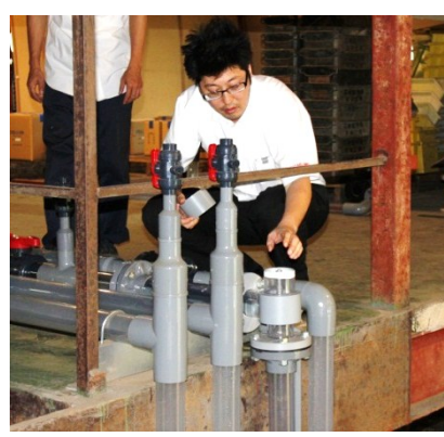
フート仕様実験配管でのメンテナンス実習@茨城工場。一次側のエルボ部にあるアングル型は配管外さず内部をメンテナンスできました。
