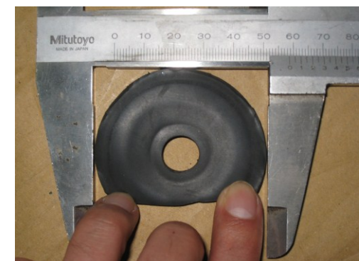
外径59mmに膨張したパッキン
