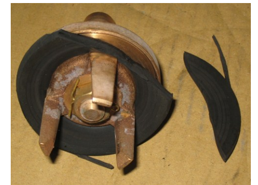
膨張し弁体をはみ出したパッキン
